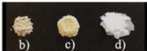
Fig. 1. Fotografía que muestra la ceniza (materia prima del proceso) señalada en b), el precipitado resultado del proceso señalado en c), y películas de carbonato de calcio de alta pureza señaladas en d), resultado del proceso.
